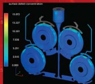
高效率的追踪模穴内的熔融金属流动模式，对于浇注系统设计的最佳化非常重要。
