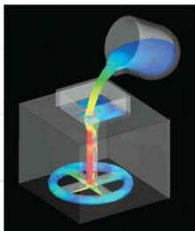
强大的 General Moving Objects 功能能够让工程师预测实际的浇注过程。设计人员甚至能够仿真实际的浇注制程，以及倾斜铸造等工艺的仿真。
