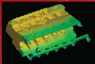
为了协助设计人员判断铸件成形后的品质好坏, **FLOW-3D** 加强了铸件在凝固过程中外观缺陷及缩孔的能力。
