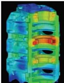
**FLOW-3D** 能够在消失模铸造中仿真成形过程, 追踪氧化膜发生区域, 及潜在的表面缺陷问题。
